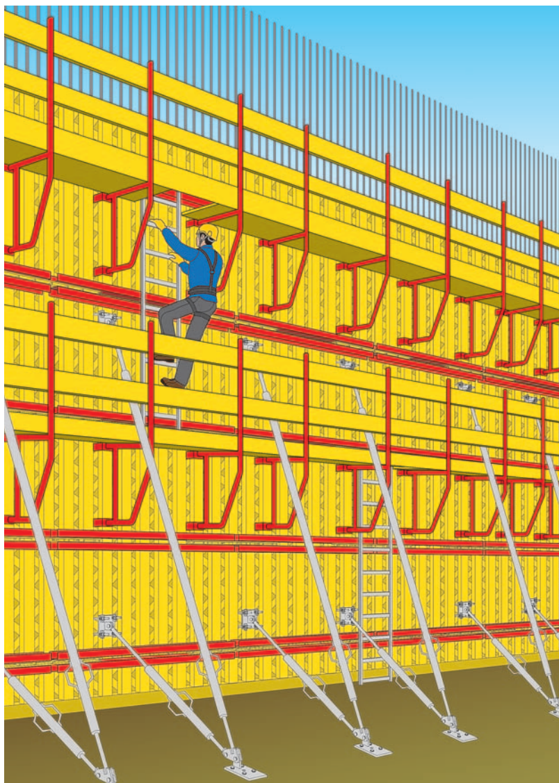
Figura 2 - Cassaforma verticale prefabbricata componibile
